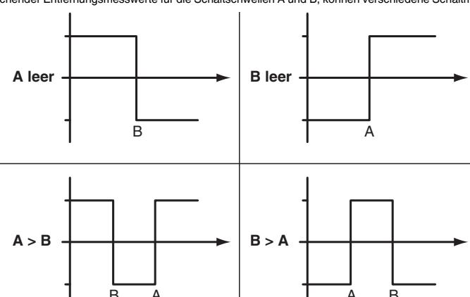
Jede eingelegte Schaltschwelle kann durch nochmaliges Drücken der SET-Taste nachgelernt, d.h. überschrieben werden.
